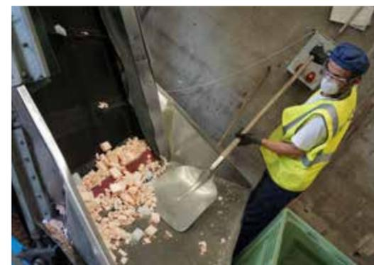
→ Les déchets finissent dans un broyeur installé en haut de ce toboggan qui fonctionne en sens inverse. Une machine assourdissante qui fait disparaître aussi prototypes d'essais et défauts de production.
