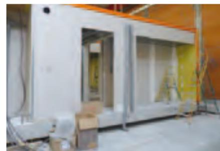
→ Les tôles acier qui constituent l'ossature métallique sont découpées au laser. Le module doit avoir une précision géométrique parfaite à la fois pour l'assemblage des éléments qu'il intègre et pour celui des modules entre eux qui constitueront au final un appartement.
